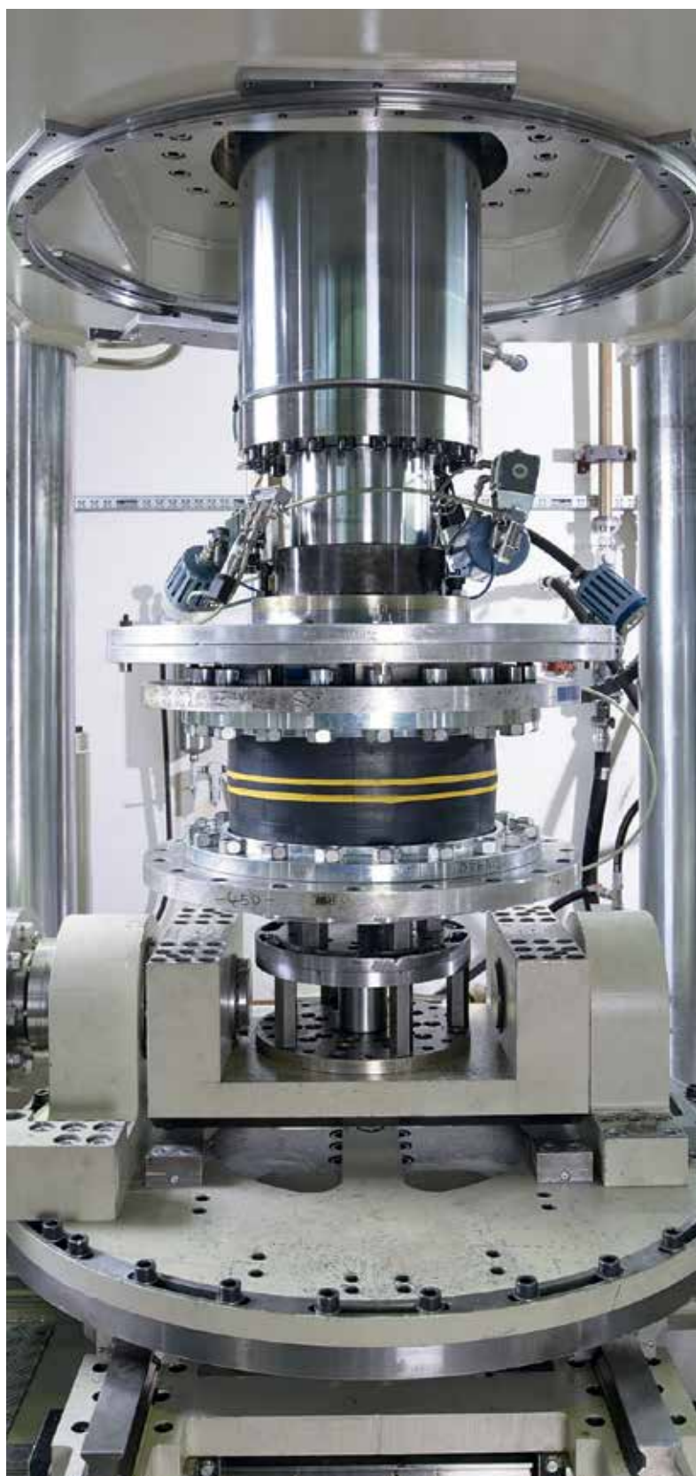
Wielofunkcyjne stanowisko testowe – na zdjęciu ekstremalne wydłużenie
